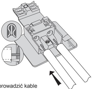
3. Wprowadzić kable antenowe do zacisków tak, aby ostrze zacisku weszło pomiędzy opłot a izolację zewnętrzną. Należy sprawdzić poprawność wprowadzenia przewodu wewnętrznego do zacisku.
