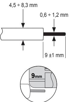
1. Przygotować końcówki kabli koncentrycznych do podłączenia - odizolować przewody wewnętrzne odcinając na tej samej wysokości izolację zewnętrzną, ekran (oplót) oraz izolację wewnętrzną - według znacznika na korpusie.
