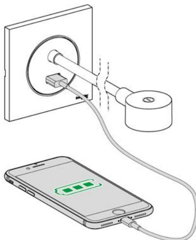
**i** Sortie/output USB: 5 V $\overline{\text{---}}$ , 2.1 A Max.
