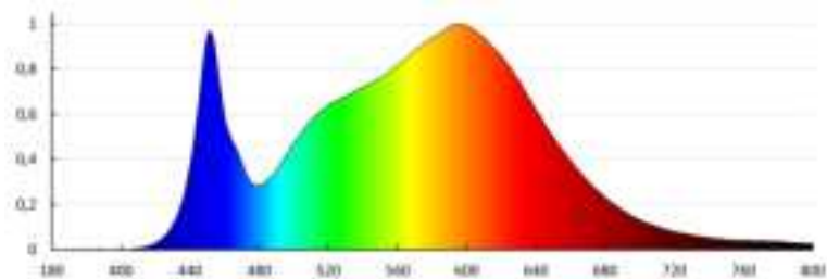
KANLUX S.A. (pat 37322) BONSA LED 17,5W NW / Krzywa rozkładu światła (dwupasmowa)
