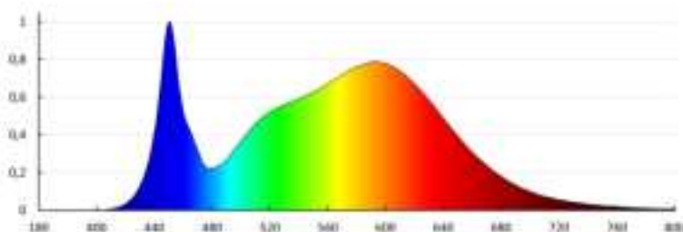
KANLUX S.A. (nr 37171) BLINGO 34W 4080 60NW / Krzywa rozkładu światła (Długotrajowo)
