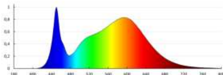
KANLUX S.A. (pat. 37292) IPER LED 26W-NW-O / Krzywa rozkładu światła (Długościowe)
