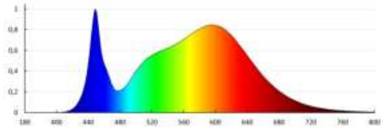
KANLUX S.A. (pat 38142) MAH PRO Y 38W 12R-NW / Krzywa mocy światła (Długonowoc)
